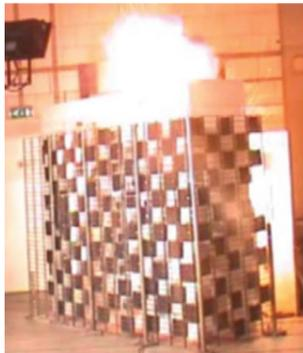
Система xEnergy **протестирована в соответствии с МЭК 61641**. С помощью специальных проводов, создавалась дуга в различных местах НКУ. В результате специальные индикаторы из хлопка (имитация эксплуатирующего персонала), не должны загореться, либо быть обожжены во время и после тестов.
