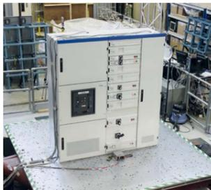
Сейсмостойкость xEnergy — AG5 по IEC, соответствует **9 баллам** по шкале MSK64 (используется в РФ).
